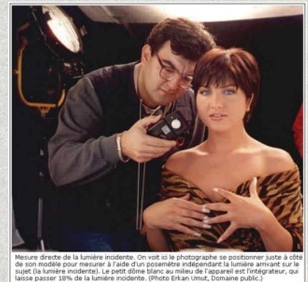
Mesure directe de la lumière incidente. On voit ici le photographe se positionner juste à côté de son modèle pour mesurer à l'aide d'un posemètre indépendant la lumière arrivant sur le sujet (la lumière incidente). Le petit dôme blanc au milieu de l'appareil est l'intégrateur, qui laisse passer 18% de la lumière incidente. (Photo Erkan Umut, Domaine public.)
